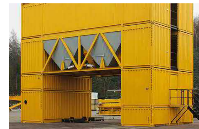
Встроенный в башню бункер-накопитель на 200 т
