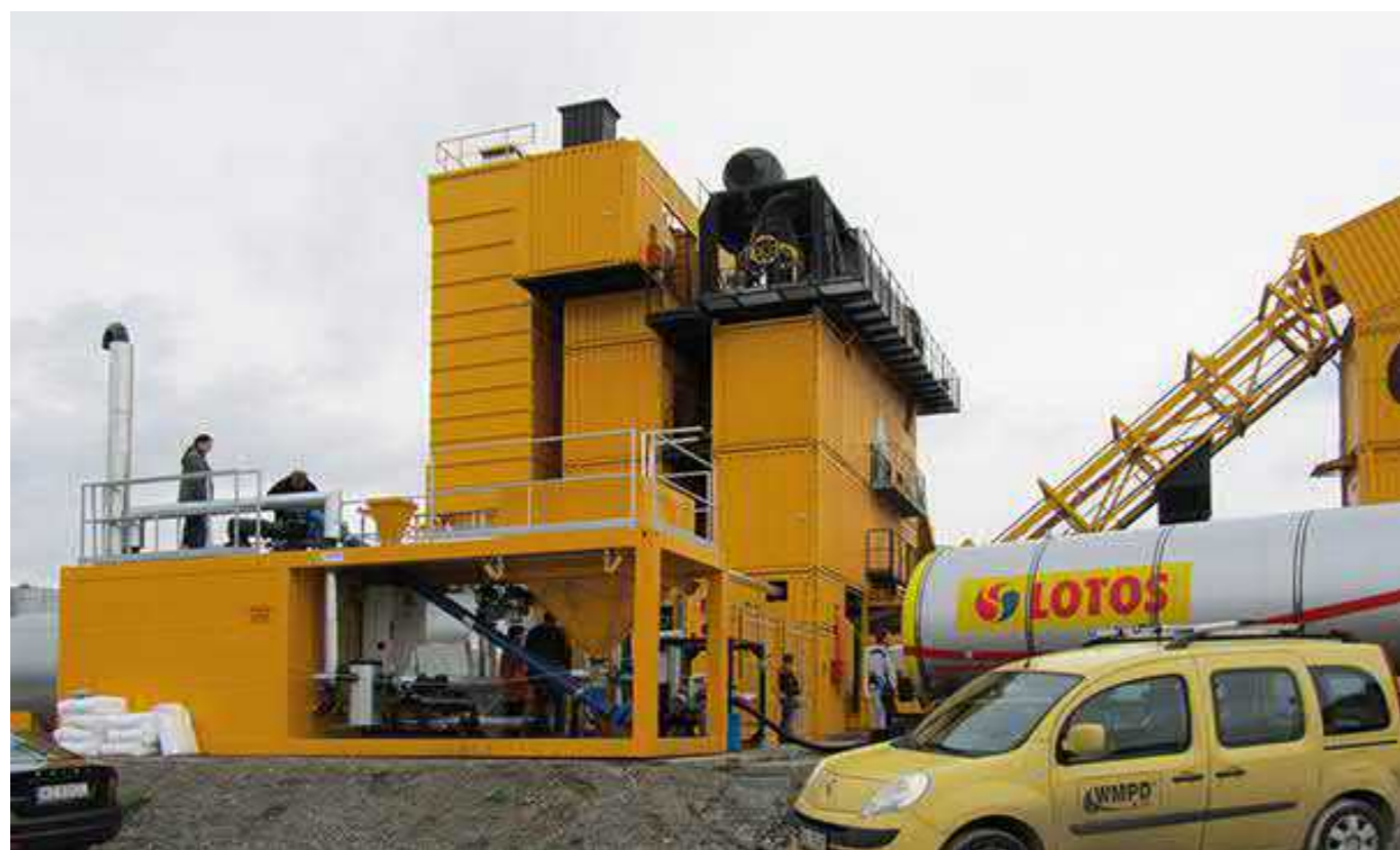
CSD 3000 со встроенной системой белого битума на производственной площадке в Польше
