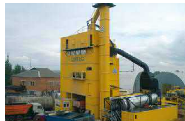
CSM 3000 – прямая отгрузка в грузовики под смесителем
