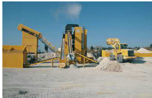
CSD 2500 – с оборудованием для вторичного асфальта
